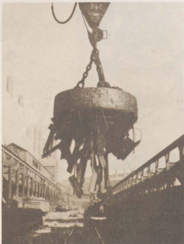
O ímã da foto é parte de um guindaste utilizado para suspender e transportar pedaços de metal. Entretanto, somente serve para transportar materiais magnéticos.
