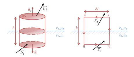
Partindo da *Lei de Gauss* ( $\oint \vec{D} \cdot d\vec{A} = q_{\text{int}}^{livre}$ ),  $d\vec{A} = dA \, \hat{n}$  e aplicando-a na *pastilha cilíndrica* acima de área  $\Delta S$  e altura h (muito pequena):
