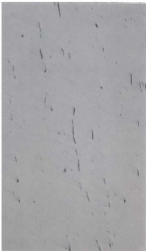
Figura 17 – Microinclusões tipo C, série fina , nível 3 e tipo D série fina , nível 2, conforme ASTM E 45.
