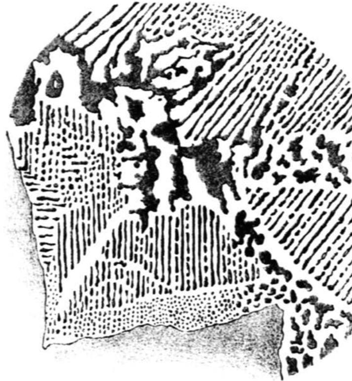
Seção metalográfica de uma amostra de aço com "Spiegeleisen" (Martens, 1878)
