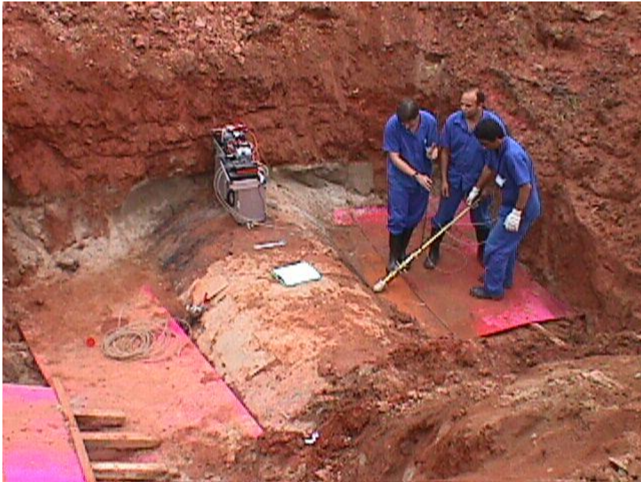
Medição com Pitot, vazão de 10 \text{ m}^3/\text{s}
