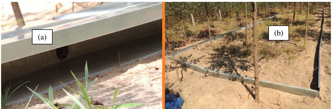
Figura 5.13 – a) calha instalada acima do nível do solo; b) solo descompactado devido à instalação das parcelas experimentais.
