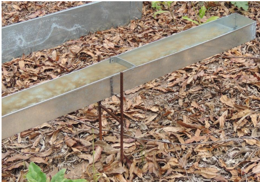
Figura 4.16 – Estrutura de aço com a finalidade de evitar a flexão da calha e manter a altura de 30 cm do solo.
