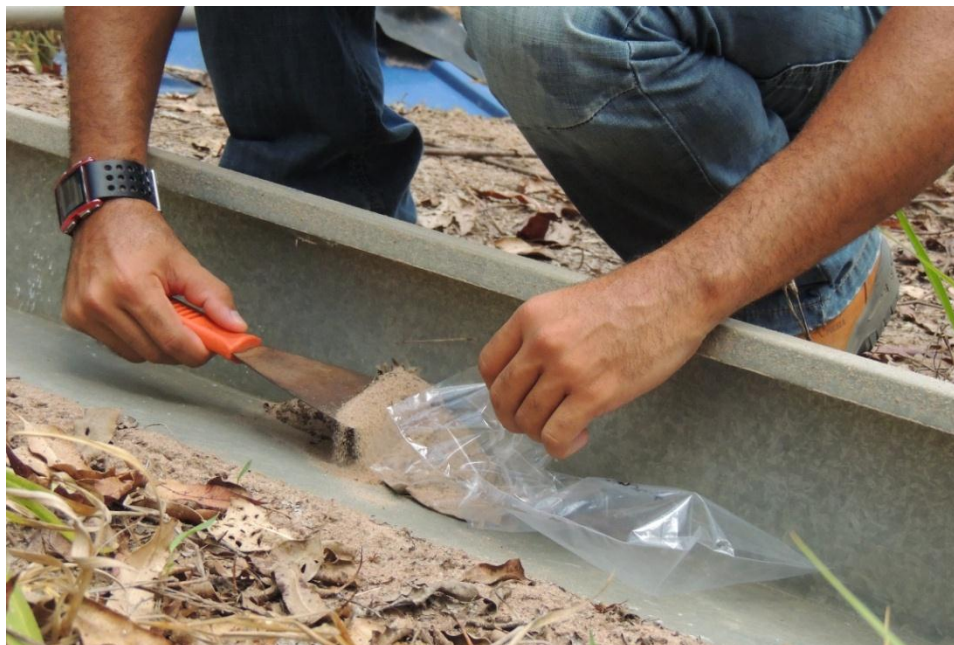
Figura 4.13 – Coleta do solo retido na calha de escoamento superficial.
