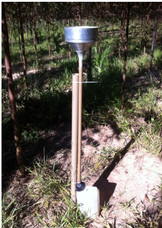
Figura 4.17 – Pluviômetro tipo Ville de Paris utilizado no experimento. Altura do solo: 1,5 m. Diâmetro do topo: 21 cm.
