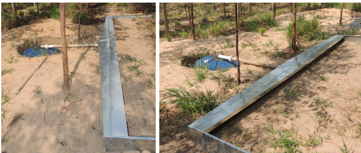
Figura 4.11 – Vista geral da tampa da calha da parcela experimental.
