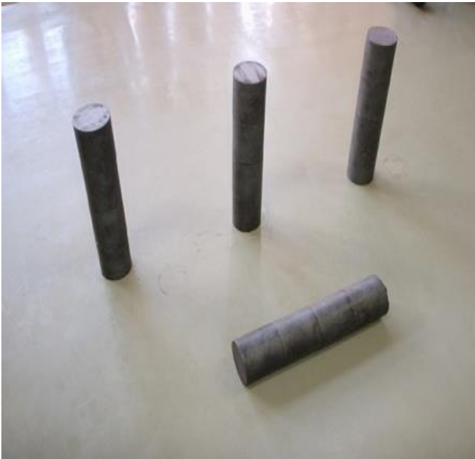
Marcadores magnéticos(ferrite) dimensão: 25x100 mm
