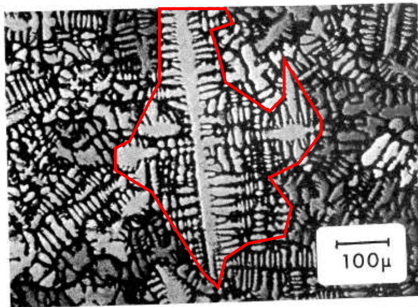
Fig. 4.9 Coring em cupro-níquel fundido com resfriamento rápido ( k_0 < 1 ): (a) estrutura fundida; (b) varredura de microsonda eletrônica entre duas ramificações dendríticas. A natureza qualitativa da segregação é mostrada como um máximo e um mínimo, respectivamente para cobre e níquel.
