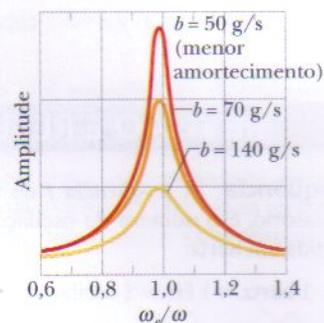
**FIG. 15-17** A amplitude do deslocamento  $x_m$  de um oscilador forçado varia quando a freqüência angular  $\omega_e$  da força externa varia. As curvas da figura correspondem a três valores da constante de amortecimento  $b$ .
