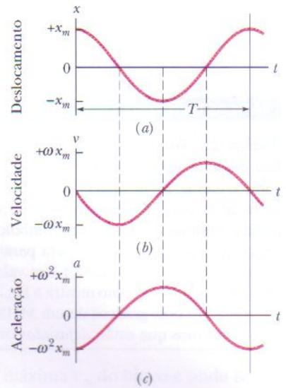
**FIG. 15-4** (a) O deslocamento  $x(t)$  de uma partícula oscilando em um MHS com ângulo de fase  $\phi$  igual a zero. O período  $T$  corresponde a uma oscilação completa. (b) A velocidade  $v(t)$  da partícula. (c) A aceleração  $a(t)$  da partícula.
