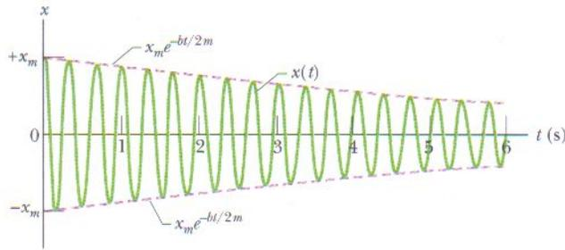
**FIG. 15-16** A função deslocamento  $x(t)$  do oscilador amortecido da Fig. 15-15, para os valores do Exemplo 15-7. A amplitude, que é dada por  $x_m e^{-bt/2m}$ , diminui exponencialmente com o tempo.
