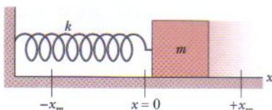
**FIG. 15-5** Um oscilador harmônico simples linear. Não há atrito com a superfície. Como a partícula da Fig. 15-1, o bloco se move em movimento harmônico simples quando é puxado ou empurrado a partir da posição  $x = 0$  e depois liberado. O deslocamento é dado pela Eq. 15-3.
