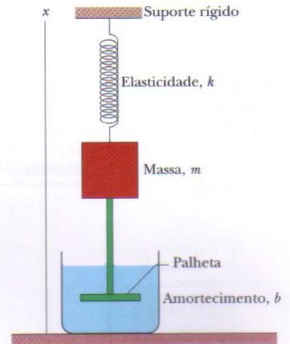
**FIG. 15-15** Um oscilador harmônico simples amortecido ideal. Uma palheta imersa em um líquido exerce uma força de amortecimento sobre o bloco, enquanto este oscila paralelamente ao eixo  $x$ .
