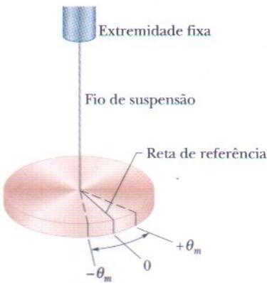
**FIG. 15-7** Um pêndulo de torção é uma versão angular de um oscilador harmônico simples linear. O disco oscila em um plano horizontal; a reta de referência oscila com amplitude angular  $\theta_m$ . A torção do fio de suspensão armazena energia potencial de forma semelhante a uma mola e produz o torque restaurador.
