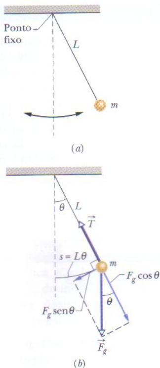
**FIG. 15-9** (a) Um pêndulo simples. (b) As forças que agem sobre o peso são a força gravitacional  $\vec{F}_g$  e a tensão  $\vec{T}$  do fio. A componente tangencial  $F_g \sin \theta$  da força gravitacional é a força restauradora que tende a levar o pêndulo de volta para a posição central.
