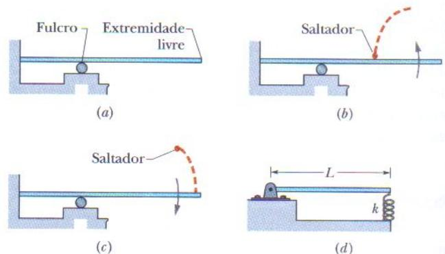
**FIG. 15-12** (a) Um trampolim. (b) O saltador pula para cima e para a frente quando o trampolim passa pela posição horizontal. (c) O saltador pisa novamente na tábua 2,5 oscilações depois. (d) Modelo do trampolim usando uma barra e uma mola.
