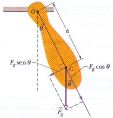
**FIG. 15-10** Um pêndulo físico. O torque restaurador é  $hF_g \sin \theta$ . Quando  $\theta = 0$ , o centro de massa  $C$  está situado diretamente abaixo do ponto de suspensão  $O$ .
