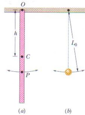
**FIG. 15-11** (a) Uma régua de um metro suspensa por uma das extremidades para formar um pêndulo físico. (b) Um pêndulo simples cujo comprimento  $L_0$  é escolhido para que os períodos dos dois pêndulos sejam iguais. O ponto  $P$  do pêndulo (a) é o centro de oscilação.
