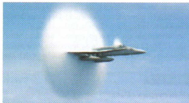
FIG. 17-24 Ondas de choque produzidas pelas asas de um jato FA 18 da Marinha dos Estados Unidos. As ondas de choque são visíveis porque a redução brusca da pressão do ar fez com que moléculas de água se condensassem, formando uma nuvem. (Foto do guarda-marinha John Gay para a Marinha dos Estados Unidos)
