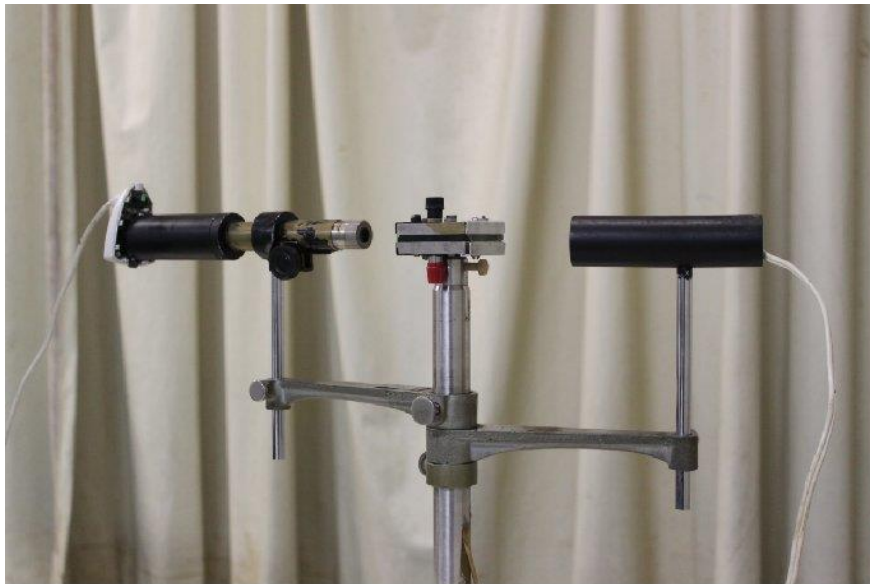
Fotografia do aparato. À esquerda, câmera de vídeo acoplada ao microscópio. No centro, capacitor de placas paralelas. À direita, fonte de luz.
