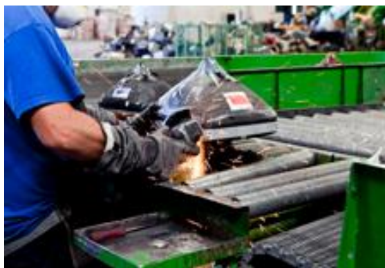
Figura 45 – Reciclagem de monitores de TRC
