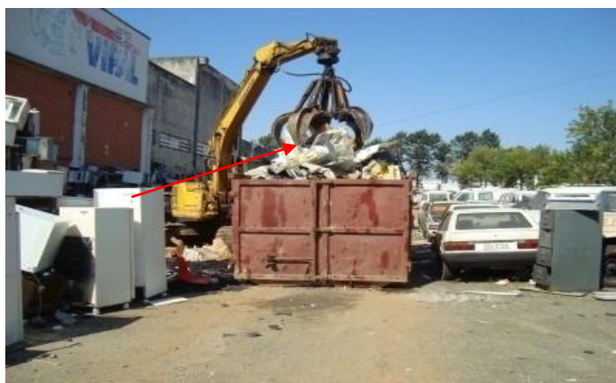
Figura 16 – Carregamento de lotes de sucata e REEE contendo gases de refrigeração, preparados para o transporte.
