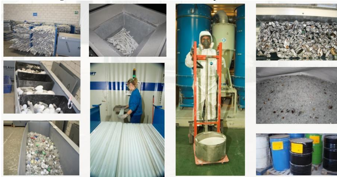
Figura 44 – Linha de Tratamento de Lâmpadas Fluorescentes
