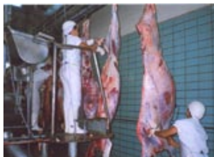
Fotos 21 e 22 – corte/serragem e limpeza das carcaças
