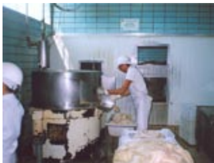
Fotos 19 e 20 – carga e descarga de máquina lavadora de buchos
