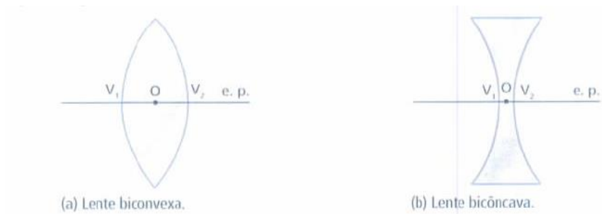
Fig. No caso de lentes simétricas, o centro óptico se situa em um ponto equidistante dos vértices dos dióptros.
