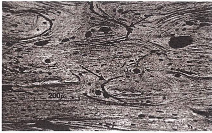
FIG. 2.12 Microfotografia eletrônica de um osso cortical humano testada em tensão (30X). As setas indicam descolamento nas linhas cimentadas e a separação dos ósteos. Cortesia de Dennis R. Carter, Ph.D.
