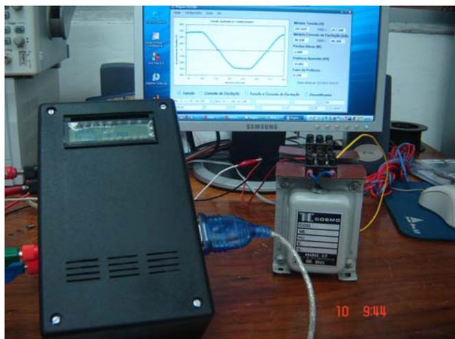
Figura 5 – Transformador monofásico de 100 VA, com núcleo de FeSi, submetido a ensaio de circuito-aberto, com o equipamento desenvolvido mostrado em primeiro plano.
