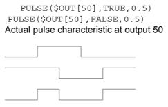
Fig. 10-8: PULSE+PULSE, example 2
