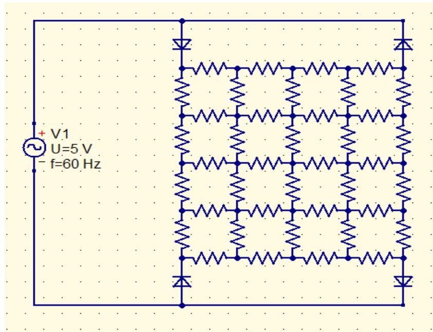
Alimentando este circuito com uma fonte alternada é possível ler uma tensão senoidal com valores de pico distintos em cada semiciclo. Cada um destes picos corresponde à equipotencial de cada uma das configurações, o que permite assim determinar a coordenada onde a medida foi feita.
