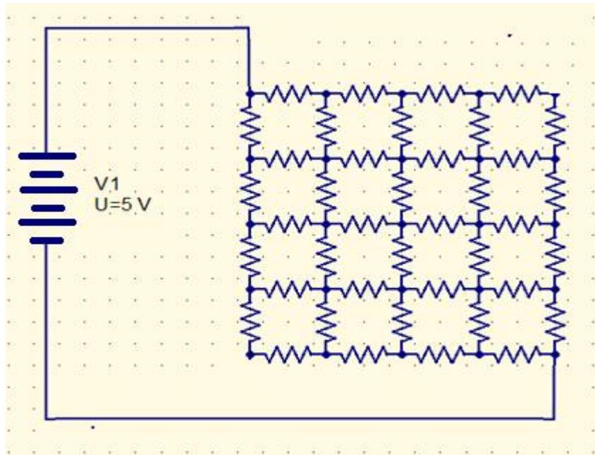
Esta seria a configuração usada para obter a distribuição de tensões por coordenadas em nossa placa resistiva.
