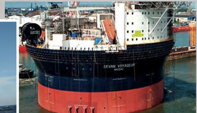
Sevan Voyageur – Mono-Hull spar type
