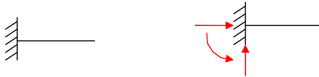
Figura 1.7: Engastamento: representação e reações.
