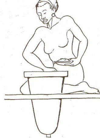
Figura 27: Barrear as fôrmas. "Botam-lhe, então, o primeiro barro e, com a palma da mão, o estendem sobre toda a cara da fôrma" (Fernandes, 1971: 82/83).
