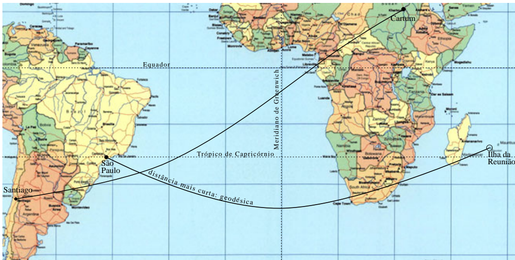
Figura 1.26: Distância mais curta entre dois pontos sobre uma superfície esférica (no caso, a Terra). Cada traço cheio, a geodésica, indica a distância mais curta entre São Paulo e a Ilha da Reunião, e Santiago e Cartum. Qualquer projeção plana ( planisfério ) de uma esfera irá deformá-la.
