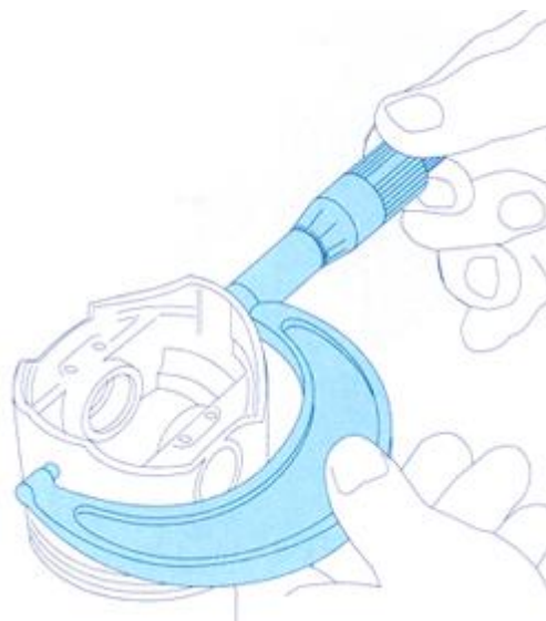
Figura 3.4 – Realizando uma medida com um micrômetro simples.
