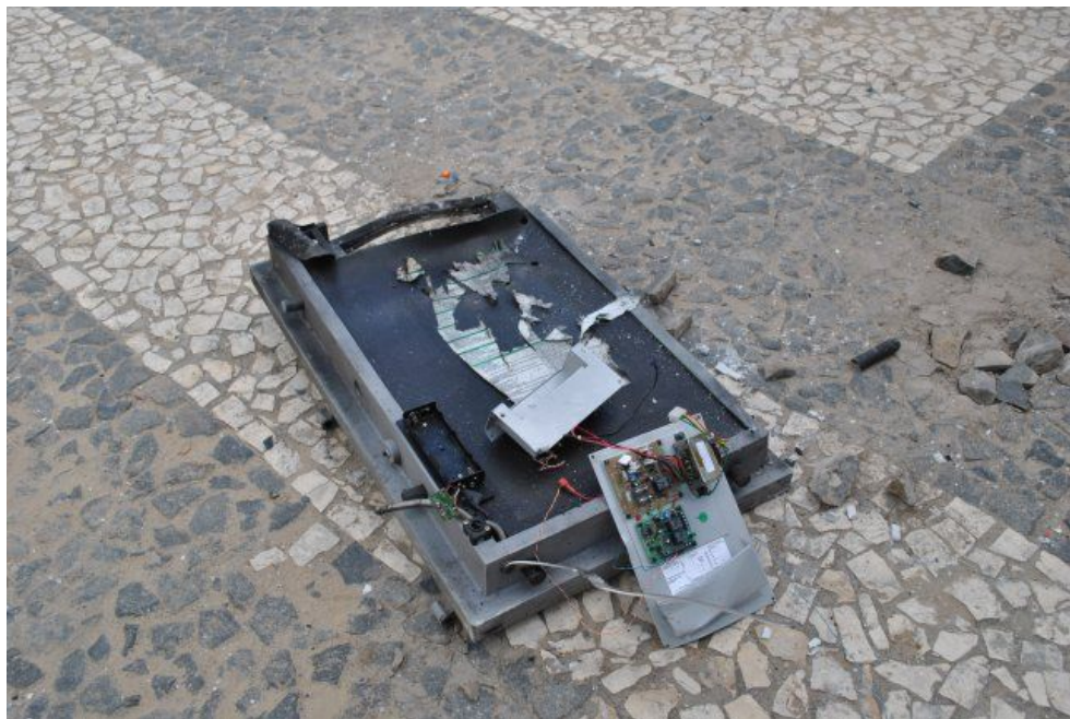
Imagem 18 - A porta do cofre foi encontrada a 8m de distância do mesmo. Possui massa de cerca de 100kg
