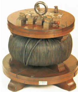
Núcleo toroidal Ganz Cia. 1885
