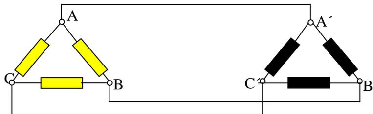
(b) - Circuito trifásico com gerador e carga em triângulo
