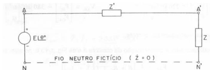
Figura 4.6. Circuito monofásico equivalente
