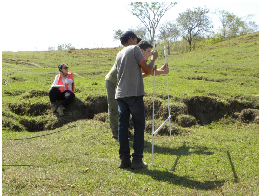
Figura 40: Exemplo de irregularidade no relevo que gera distorções nos dados de declividade mensurados em campo com o uso do pantômetro.
