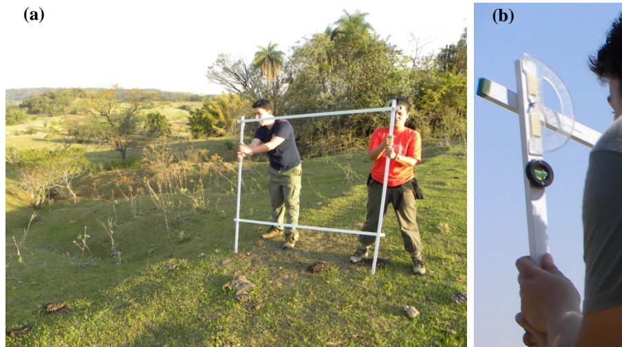
Figura 14: Exemplo da utilização do pantômetro na mensuração da declividade a montante da cabeceira de uma feição erosiva (a) e, detalhe da leitura do ângulo no transferidor e do nível de bolha (b).
