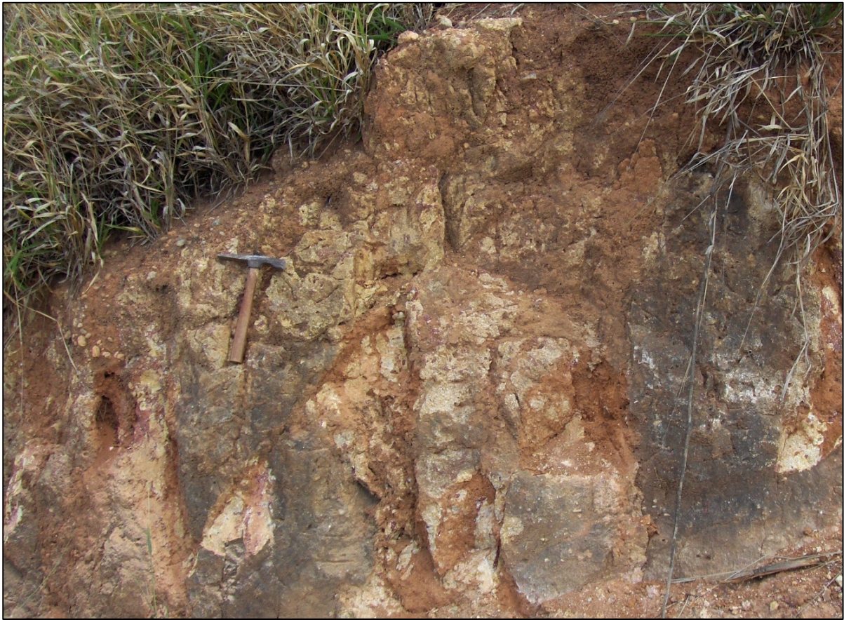
Figura 5-67: Duas famílias de juntas conjugadas em ferricrete alterada da Formação Itaqueri. Localização: 200.539; 7.510.352. Fuso 23. Autor: PINHEIRO, 24/08/2013.
