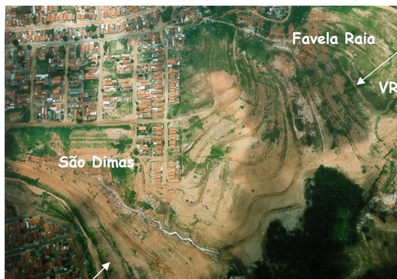
Figura 5.5: Vista aérea de baixa altitude de parte da área, observa-se que em 2001, a voçoroca com ravina, localizada na favela Raia foi controlada pela construção de cordões e encontrava-se estável.
