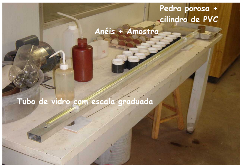
Figura 3.2- Esquema do ensaio de absorção de água.
