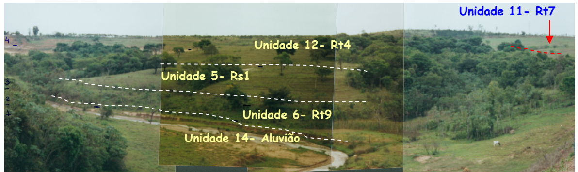
Figura 5.13: Materiais inconsolidados representativos da unidade 5, 6, 11, 12 e 14 localizado entre o leito do canal do Tucum e a Fazenda.
