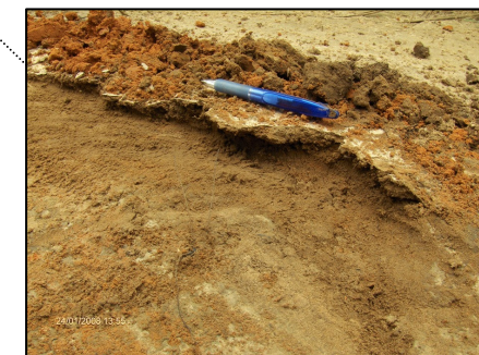
Foto 2-10: Crosta na superfície do solo que reduz a infiltração da água.
