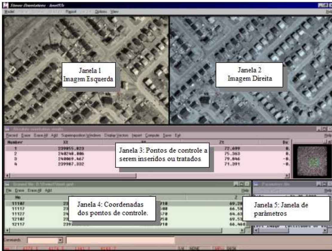
Figura 3-5: Esquema de identificação dos pontos de controle nas fotos e inserção das coordenadas X, Y e Z.
