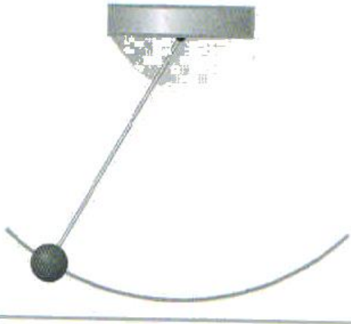
FIGURA 3-21 A massa de um pêndulo oscila ao longo de um arco circular centrado no ponto de suspensão do fio.
