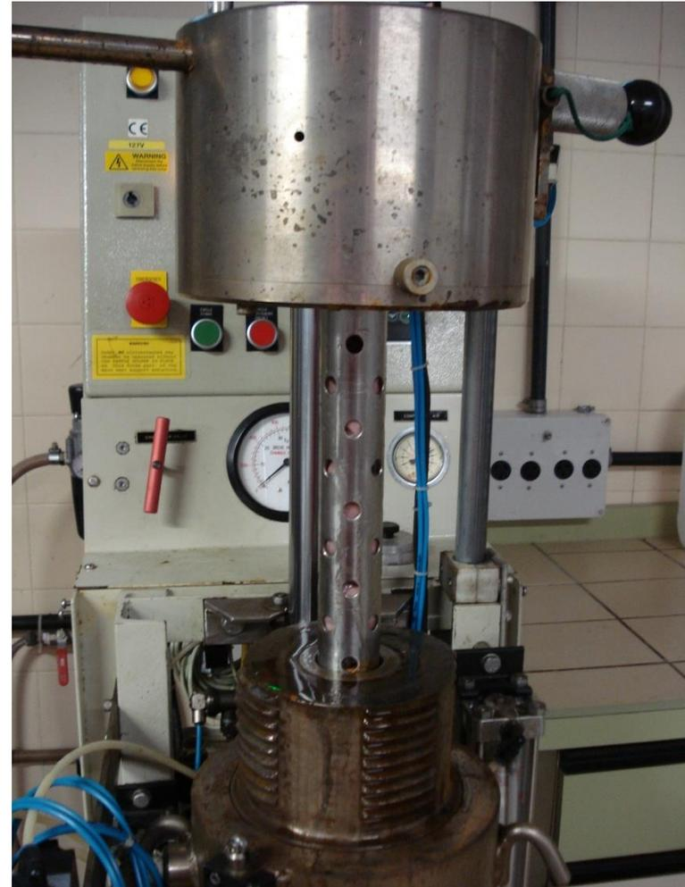
EMBRAPA Equipamento de alta pressão hidrostática em escala piloto, fechado(1) e aberto (2)
