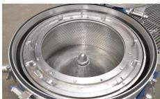
Combina as operações de filtração e de centrifugação.
