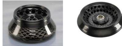
O rotor forma ângulo de 45°-50° com o eixo do aparelho, os tubos mantêm sempre a posição angular, obtendo-se maiores velocidades e melhor sedimentação. O caminho da partícula no tubo é menor (será direcionada à parede do tubo e depois ao seu fundo) e a sedimentação, mais fácil e rápida.
