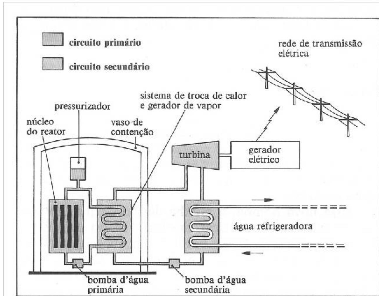
Esquema de construção de um reator nuclear do tipo Angra I
