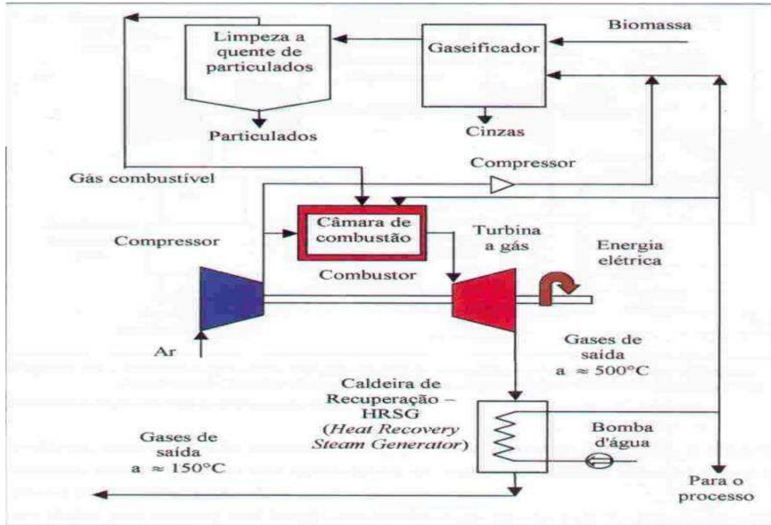
Figura 14 - Turbina a gás com injeção de vapor integrado a gaseificador de biomassa - Biomass Integrated Gasifier/Steam Injected Gas Turbine (BIG/STIG).
