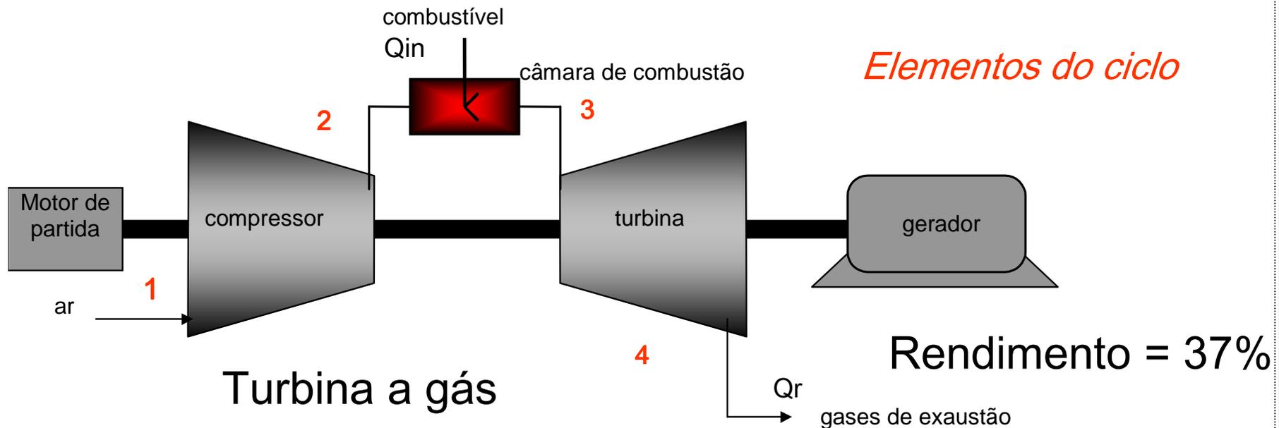
Trabalho líquido  $\rightarrow q_{in} - q_r = c_p (T_3 - T_2) - c_p (T_4 - T_1)$
