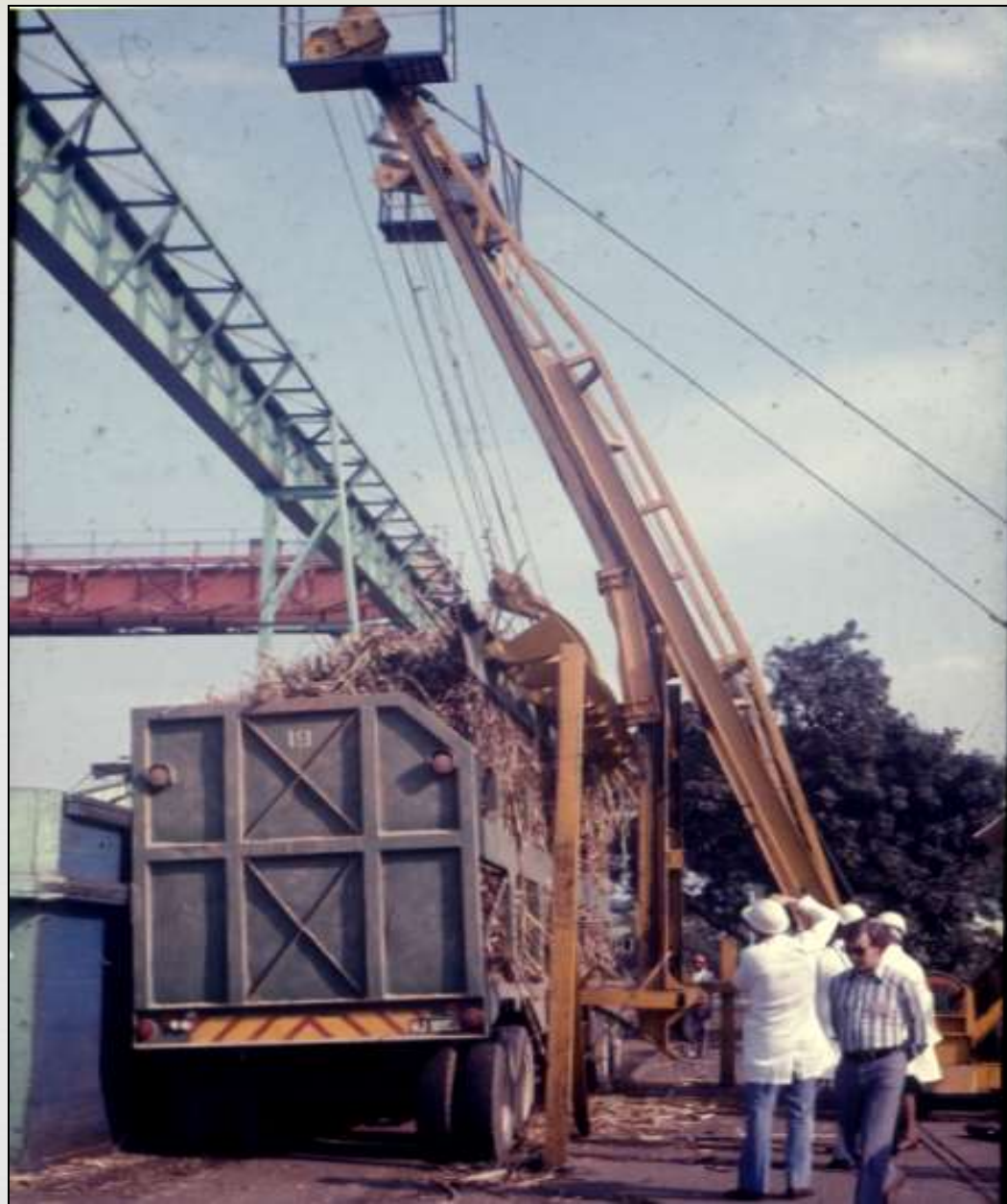
guindaste lateral “Hilo” sustentado por cabos
