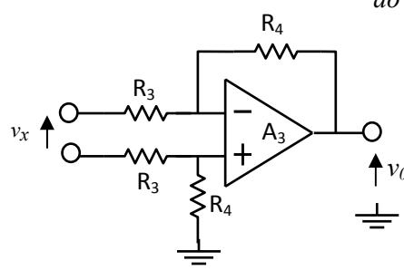
$$v_0 = -\frac{R_4}{R_3} \cdot v_x$$
