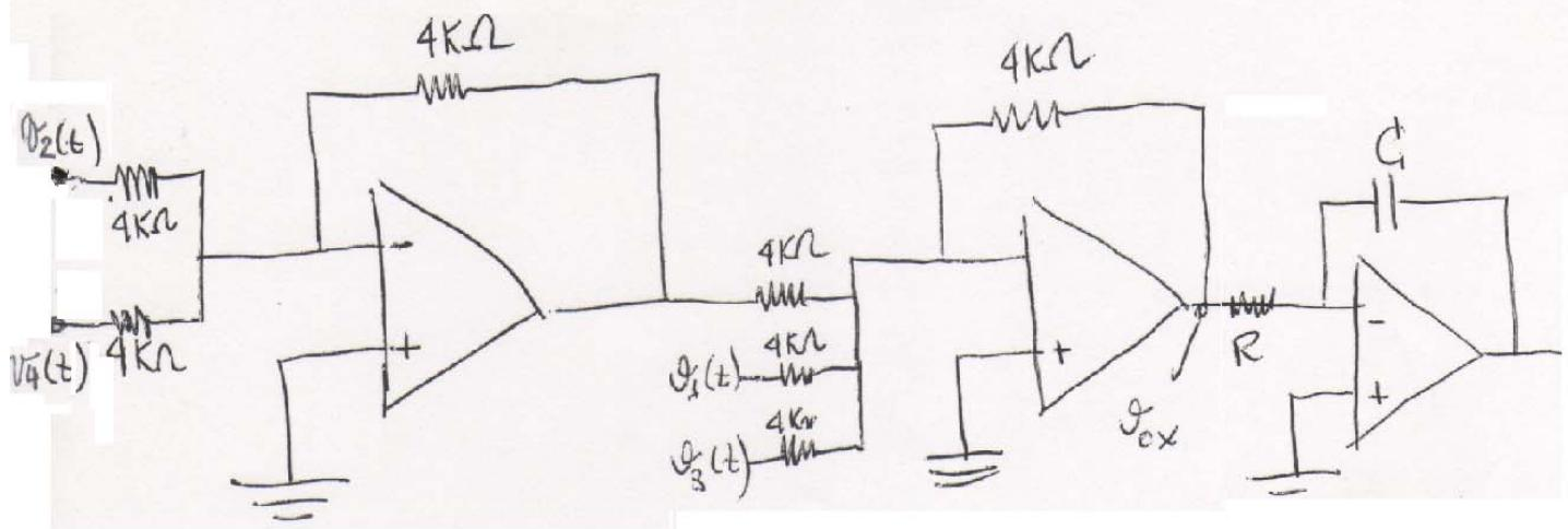
$$\vartheta_{ox}(t) = -[v_1(t) - v_2(t) + v_3(t) \Rightarrow v_4(t)]$$
