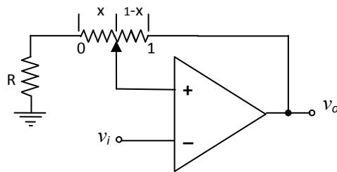
$$A_v = 1 + \frac{(1-x) \cdot 10k\Omega}{x \cdot 10k\Omega + R} = \frac{10k\Omega + R}{x \cdot 10k\Omega + R} \quad \text{com } R \text{ (k}\Omega\text{)}$$
