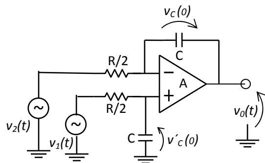
$$em que: \quad v_0(t) = v_0(0) + \frac{2}{RC} \int [v_1(t) - v_2(t)]dt$$
