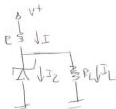
$$V^+_{\max} = V_Z + R \cdot I = 6,4 \text{ V} + 400 \cdot 264 \text{ mA} = 6,4 \text{ V} + 10,56 \text{ V} = 16,96 \text{ V}$$
