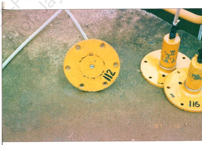
Figura 6.34 Vista das flanges com os transdutores de pressão já instalados.
