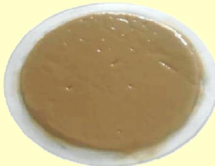
Reboco formado em papel de filtro após ensaio para determinação do volume de filtrado.
