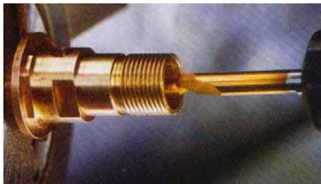
Figura 17 - Ferramenta de torneamento interno para micro-usinagens
