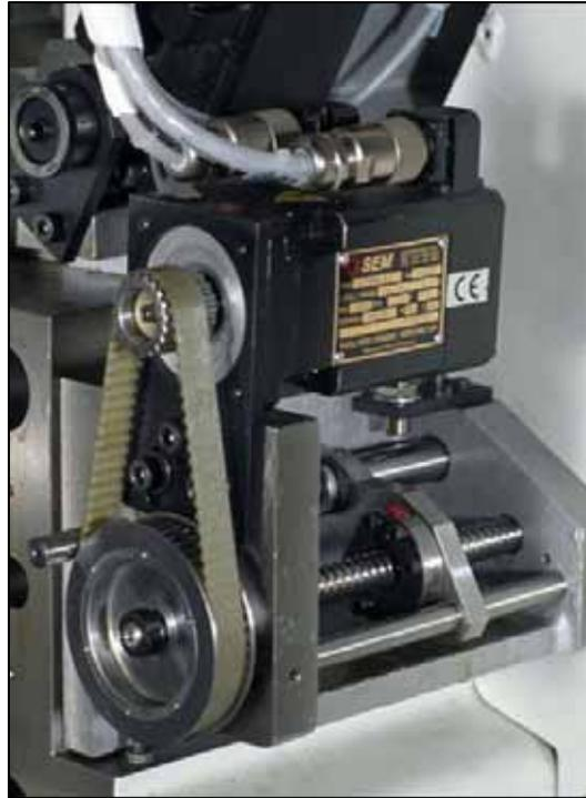
Figura 3 - Servo-motor e eixo de esferas recirculantes
