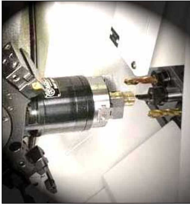
Figura 9 - Cabeçote de agarre acionada para operações posteriores
