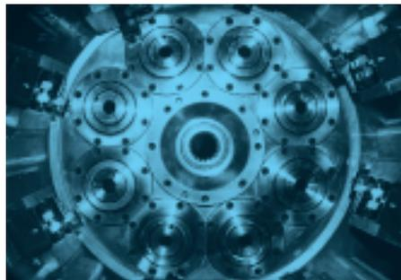
Fig. 3 - Torno automático multifuso com tambor de 8 fusos.
