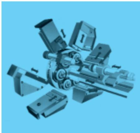
Fig. 6 - Torno automático Ergomat TB 42 equipado com dispositivo revólver estrela
