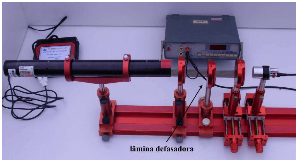
Figura 10 – Fotografia da montagem experimental. A lâmina de meia onda é posicionada entre dois polarizadores.
