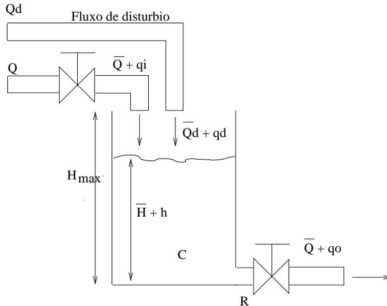
O sistema pode ser representado através de funções de transferência realizando uma linearização do sistema em torno de um ponto de operação nominal estacionário  $(\bar{H}, \bar{Q})$ . A equação linearizada que descreve o sistema é dada por:
