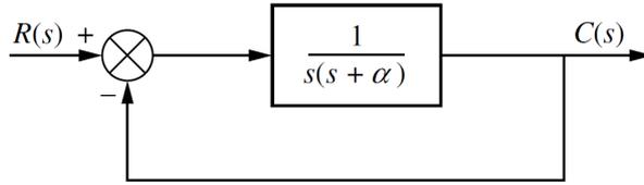
[Q. 6] Um sistema de controle para um laser cirúrgico acoplado a um manipulador com motor CC pode ser utilizado em operações ortopédicas de quadris. Tais cirurgias requerem alta precisão de posição e velocidade. O sistema de controle em malha fechada é dado por:
