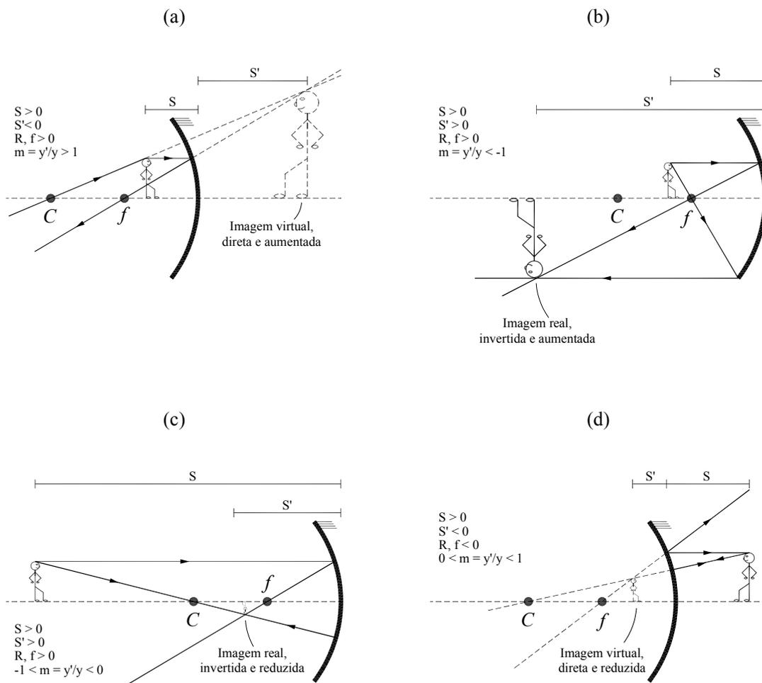
**Figura 3 – Imagens formadas por espelhos. (a) Espelho côncavo com objeto localizado entre o foco e o vértice do espelho; (b) Espelho côncavo com objeto localizado entre o centro de curvatura e o foco do espelho; (c) Espelho côncavo com objeto localizado fora do centro de curvatura do espelho; (d) espelho convexo.**
