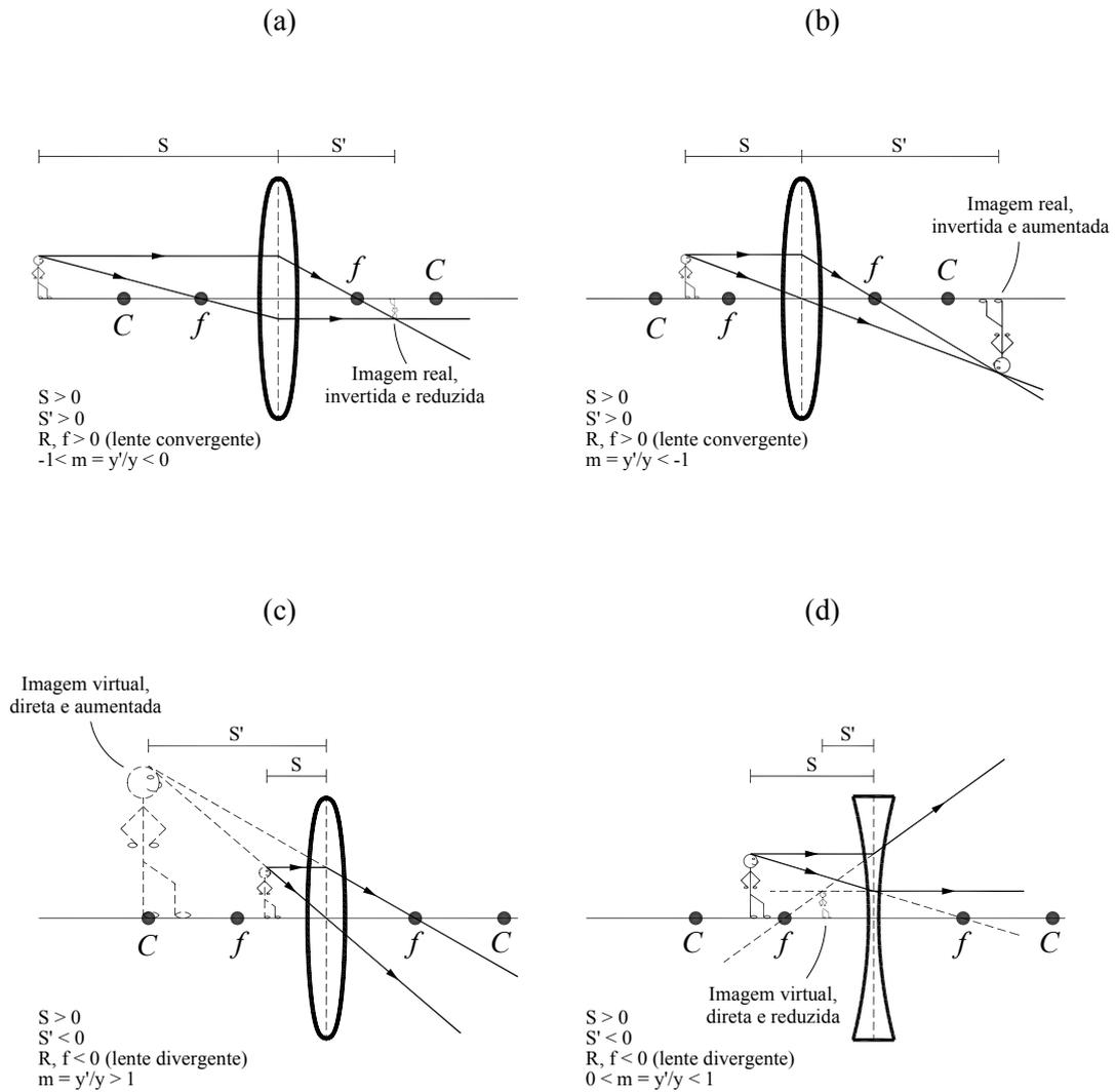
**Figura 6 – Imagens formadas por lentes delgadas. Objeto localizado (a) antes do centro de curvatura de uma lente convergente; (b) entre o foco e o centro de curvatura; (c) entre o foco e o vértice de uma lente convergente; (d) Entre o foco e o centro de curvatura de uma lente divergente.**
