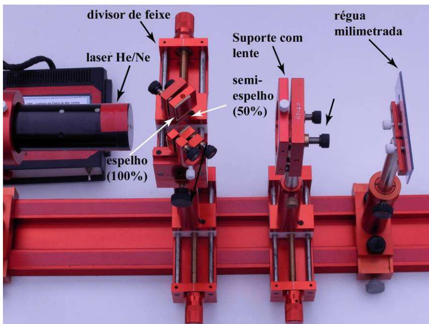
**Figura 8 – Fotografia da montagem experimental, mostrando, da esquerda para a direita, o laser, o divisor de feixes, o suporte com a lente e a régua transparente.**
