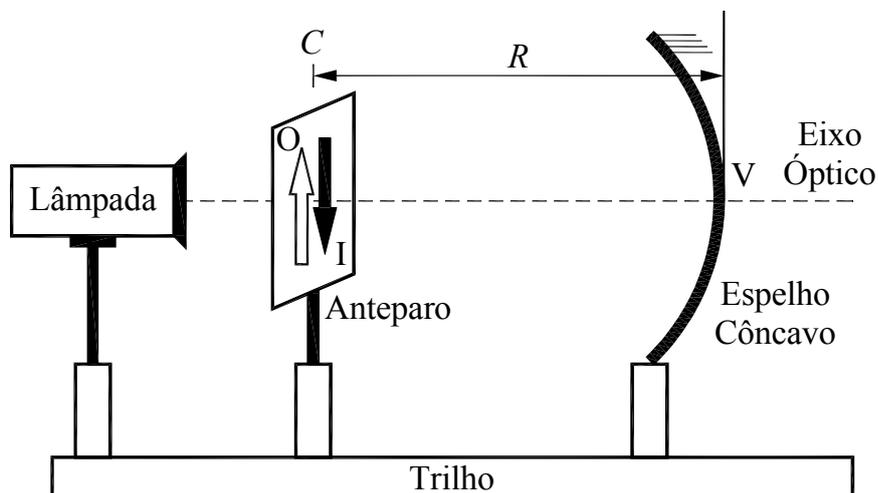
Figura 11 – Montagem experimental para determinação do centro de curvatura de um espelho côncavo utilizando uma lanterna.
