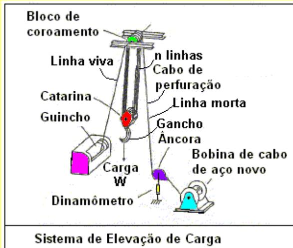
O sistema de elevação consiste em um sistema de polias. Um sistema de polias é uma máquina simples clássica, como o plano inclinado e a alavanca. A carga na linha morta,  $F_d$ , será igual à carga no gancho,  $W$ , dividida pelo número  $n$  de linhas entre o bloco de coroamento e a catarina.
