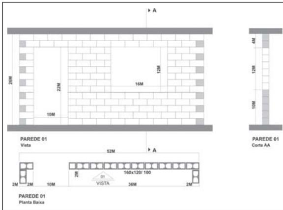
**Figura 8:** Planta e elevação de alvenaria projetada de acordo com os conceitos de coordenação modular
