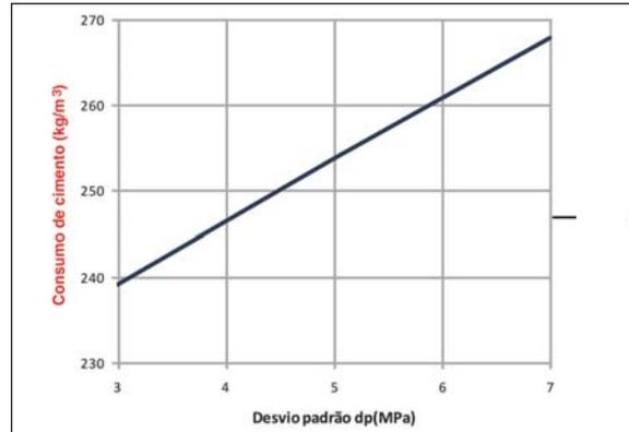
**Figura 12:** Influência do desvio padrão de dosagem no consumo de cimento ( $kg/m^3$ ) para se produzir um mesmo concreto com 25MPa de resistência, utilizando-se 165  $kg/m^3$  de água de amassamento
