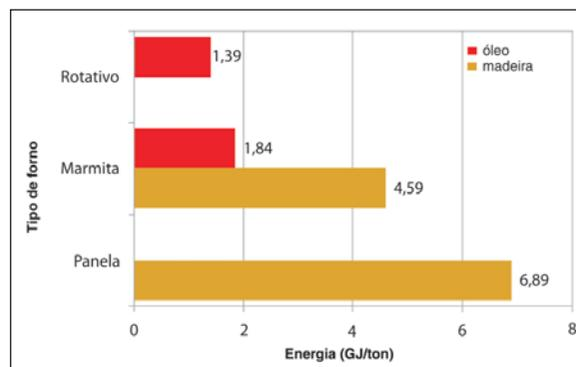
**Figura 3:** Consumo de energia na fabricação do gesso por diferentes tecnologias de forno. Dados calculados a partir de Peres, Benachour & Santos (2001). O consumo brasileiro para a produção de clínquer é de 3,45 GJ/t
