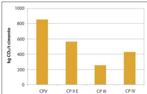
**Figura 14:** Comparação entre as emissões de CO<sub>2</sub> de diferentes tipos de cimentos brasileiros confeccionados. Neste estudo, todas as adições ativas consideradas foram residuais
