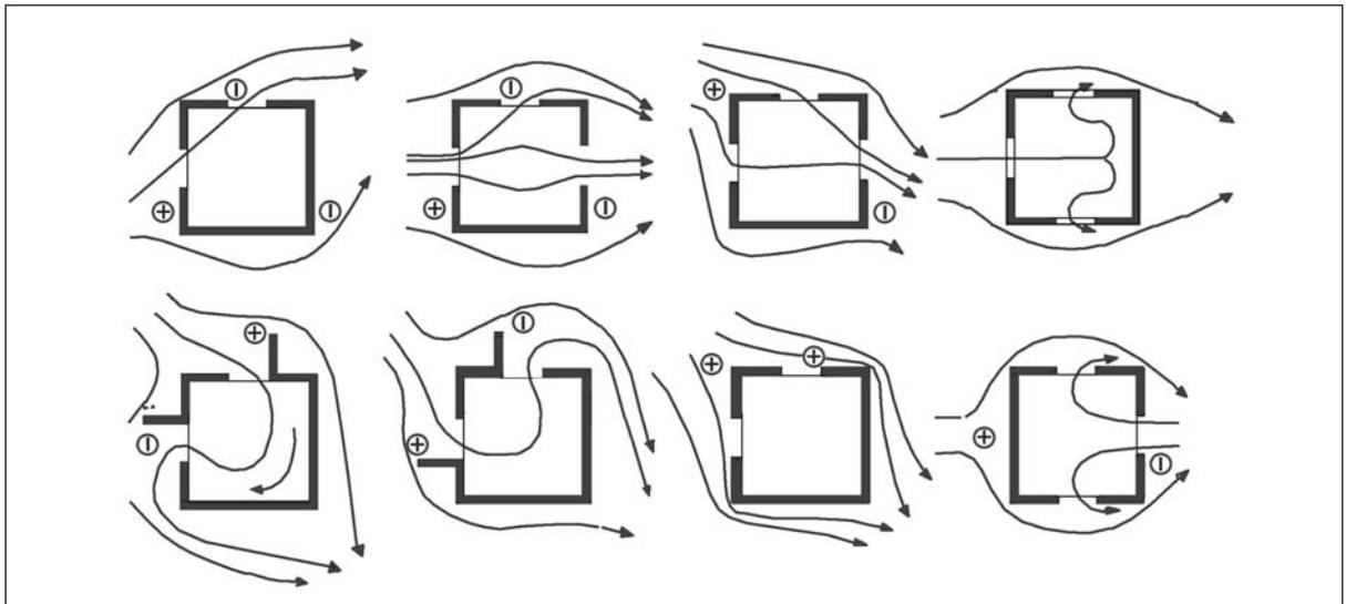
**Figura 27:** Pressões positivas (+) e negativas (-) ao redor de diferentes configurações de edificações
