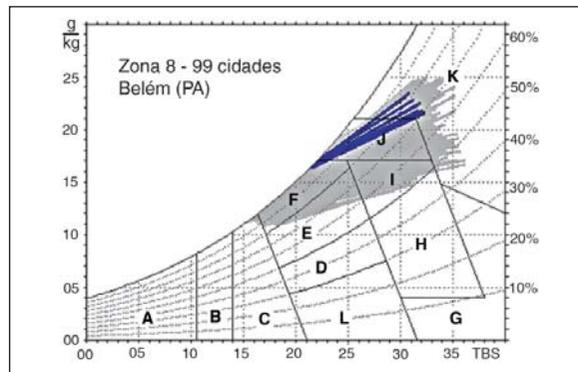
**Figura 37:** Carta bioclimática adaptada da NBR 15220-3, apresentando as normais climatológicas de cidades da zona 8 (cor cinza), destacando-se as normais climatológicas da cidade de Belém, Pará (cor azul)
