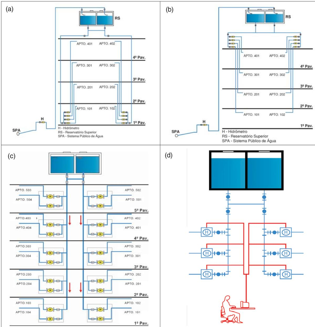
**Figura 1:** Configurações para sistemas de medição individualizada com os medidores agrupados no térreo (a), com medidores agrupados no barrilete (b), com medidores em cada pavimento (c) e com medidores em cada pavimento com a leitura remota centralizada no térreo (d)
