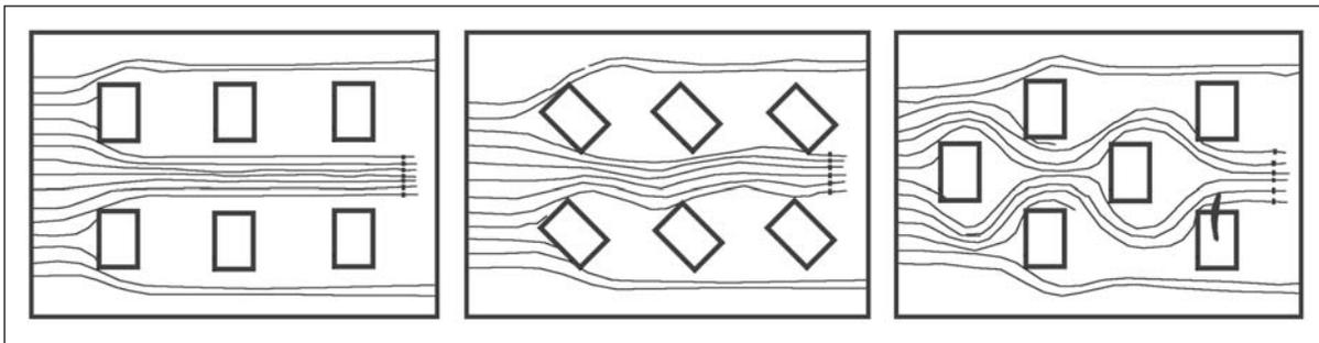
**Figura 26:** Fluxo dos ventos com edificações dispostas de forma linear, a 45° da direção do vento e de maneira intercalada
