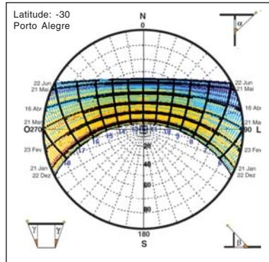
**Figura 9:** Carta solar para Porto Alegre com temperaturas plotadas até 21 de junho. Programa Sol-AR 6.2
