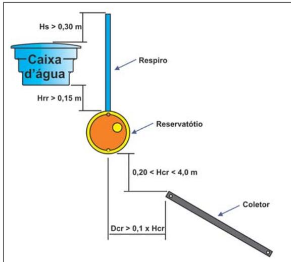
**Figura 17:** Esquema de distâncias recomendadas entre componentes de um SAS com circulação por termostifonagem
