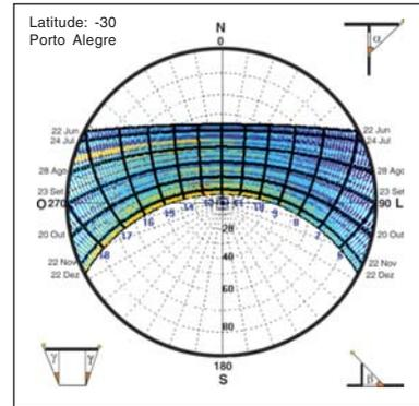
**Figura 10:** Carta solar para Porto Alegre com temperaturas plotadas após 21 de junho. Programa Sol-AR 6.2
