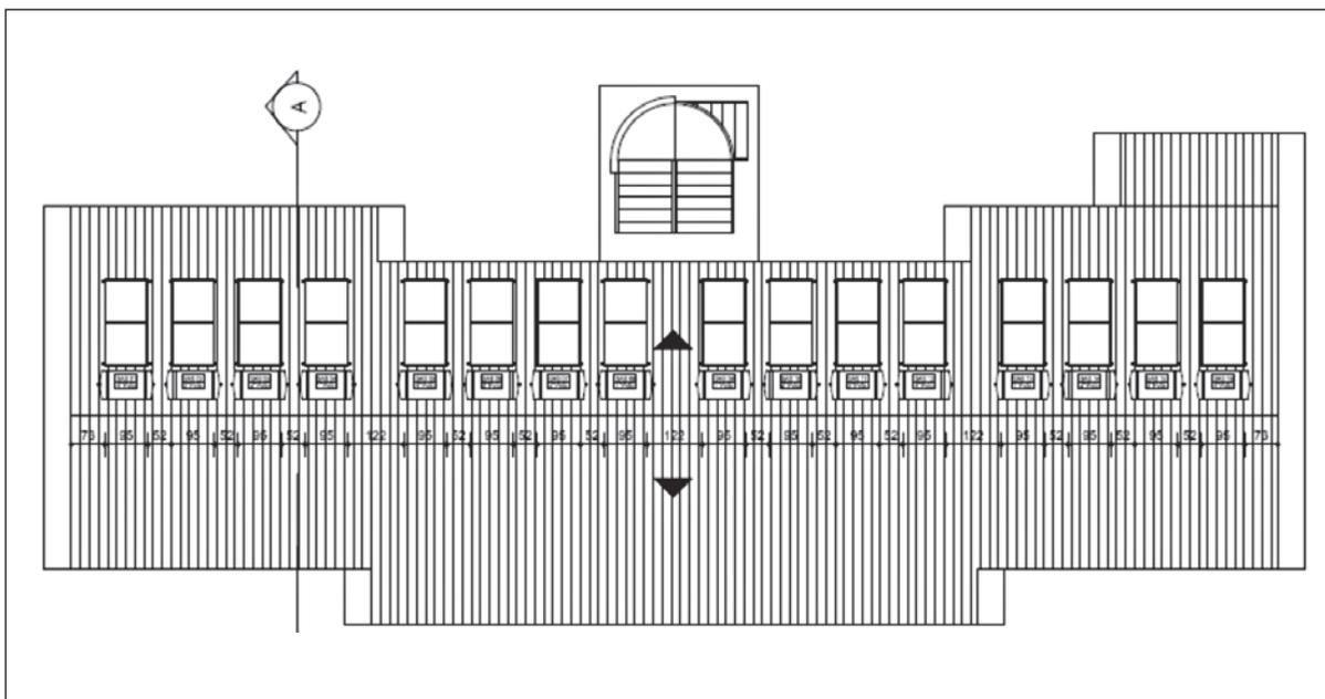
Figura 15: Projeto PAR<sup>8</sup> Mangueira/RJ – detalhe do telhado com um equipamento de aquecimento solar para cada unidade
