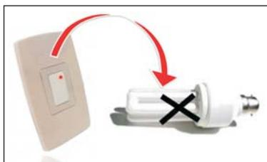
Figura 7: Minutaria sem uso de lâmpada fluorescente
