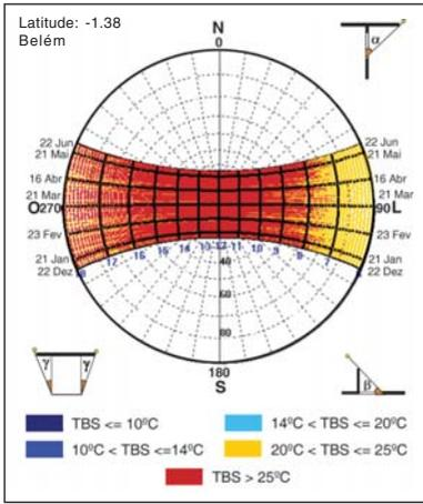
**Figura 8:** Carta solar para Belém com temperaturas plotadas até 21 de junho. Para esta cidade, não há diferenças significativas de temperatura ao longo do ano. Programa Sol-AR 6.2
