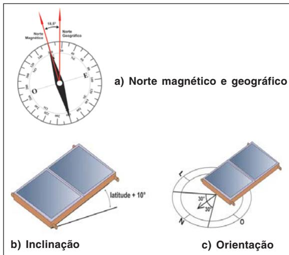
Figura 12: Ângulos fundamentais para posicionamento do coletor
