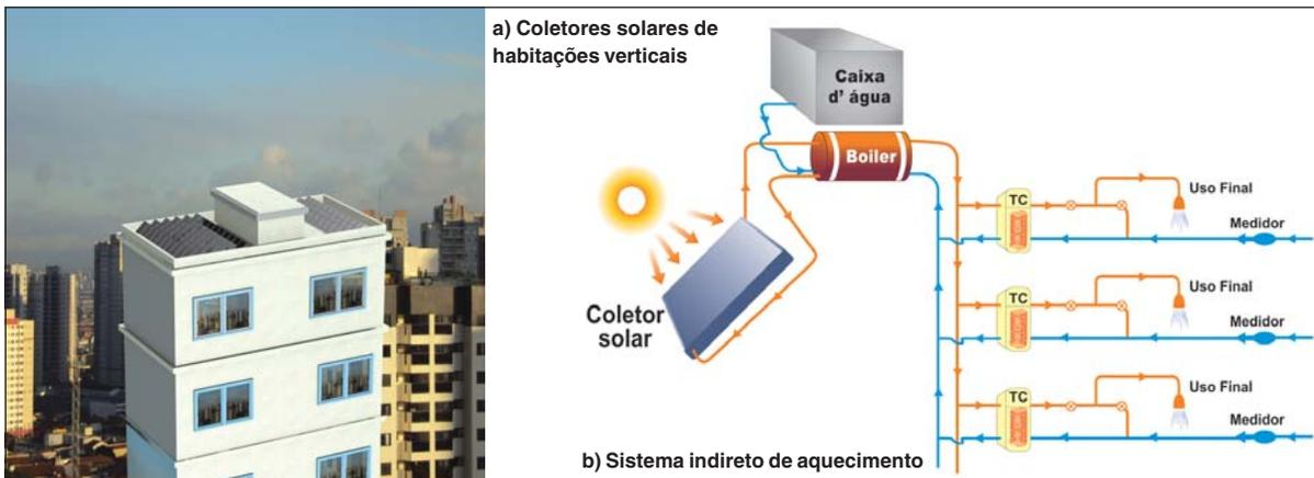
Figura 14: Coletores solares de edifício vertical multifamiliar
