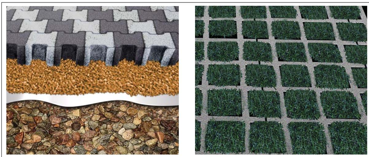
**Figura 9:** Pavimentos permeáveis. À esquerda pavimento com blocos de concreto permeáveis sobre camada de brita isolada por geotêxtil. À direita, “concregrama” apoiado sobre o solo.
