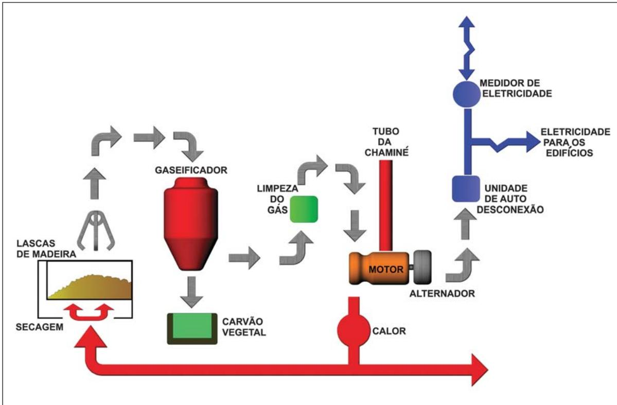
**Figura 27:** Esquema de funcionamento de miniestação para produção de calor e energia combinada (*combined heat and power*). Parte da energia produzida no local para aquecimento de água e energia elétrica é efetuada por meio da miniestação, que utiliza lascas de madeira. Projeto: Bedzed, Inglaterra, 2001. Arquiteto Bill Dunster<sup>20</sup>
