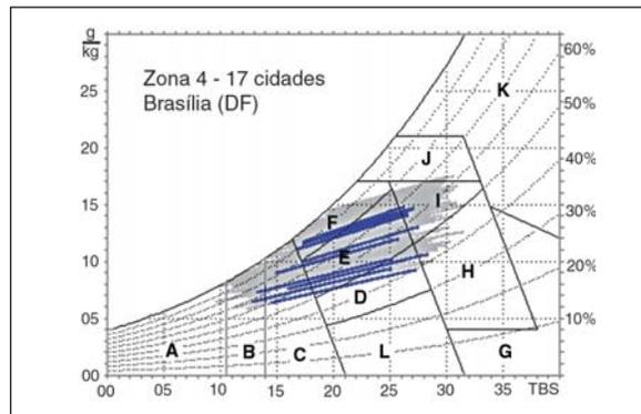
**Figura 39:** Carta bioclimática adaptada da NBR 15220-3, apresentando as normais climatológicas de cidades da zona 4 (cor cinza), destacando-se as normais climatológicas da cidade de Brasília, Distrito Federal (cor azul)
