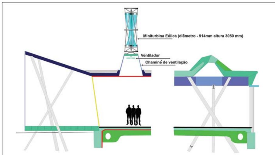
Figura 26: Projeto The Ford Calumet Environmental Center, que incorpora 12 turbinas eólicas que geram energia para alimentar ventiladores<sup>19</sup>
