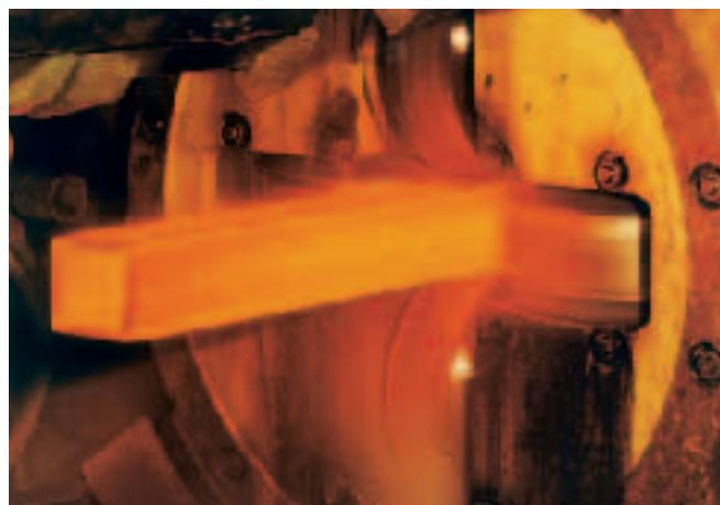
aquecidos à temperatura propícia à deformação em forno de soleira rotativa, são previamente perfurados numa prensa para obterem a forma de blocos ocos com fundo, e de seguida, alongados no lami-
