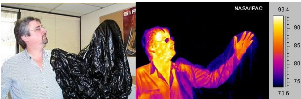
Figura 2.5: Radiação infravermelha emitida pelo corpo humano (direita). Na figura da esquerda a mesma cena registrada com luz visível.
