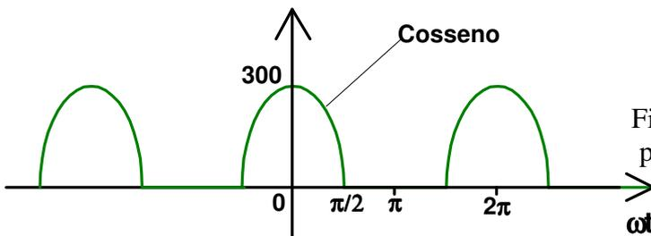
Figura 10 - Forma da tensão produzida por um retificador de meia onda.
