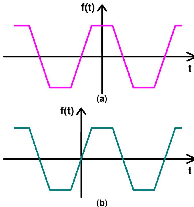
Figura 6 - (a) simetria de quarto de onda par (b) simetria de quarto de onda ímpar
