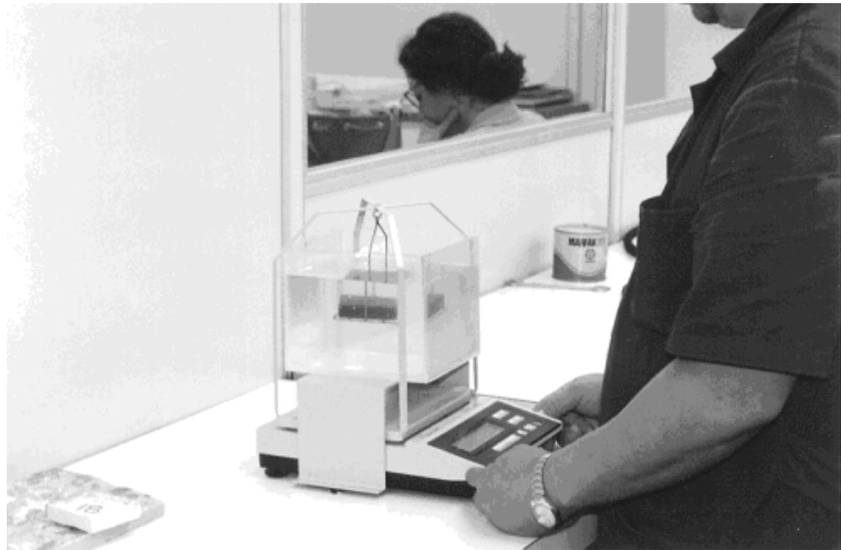
**Balança para o método gravimétrico de Arquimedes**
