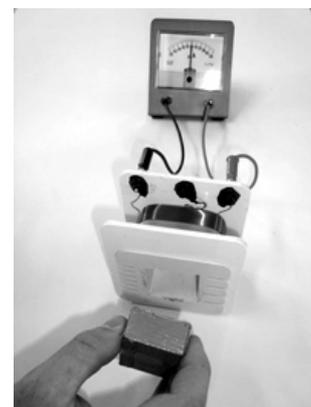
Figura 14 - Galvanômetro conectado à bobina
