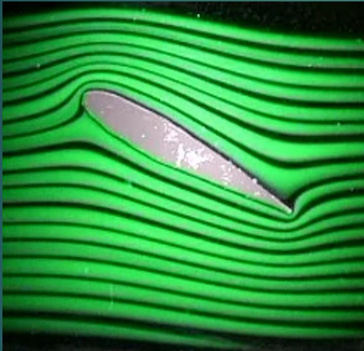
Figura 4: Escoamento 2-D irrotacional.
